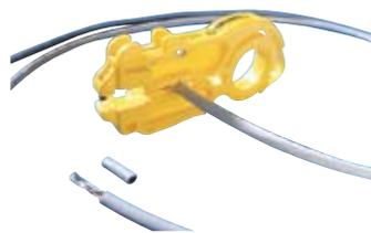
Просто вставьте кабель, закройте инструмент и один раз поверните его. Инструмент включает вырезы для пяти различных диаметров кабеля, шаблон длины зачистки, продольное лезвие для снятия оболочки, а также пружинную петлю и регулировочный винт для управления глубиной проникновения лезвия
