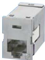
Экранированные розеточные модули Clarity TracJack, RJ45 (8P8C), соответствуют требованиям к компонентам категории 6a по TIA и точно согласованы по характеристикам с вилками патч-кордов Clarity, что обеспечивает оптимальную производительность канала, которую можно измерить при тестировании в полевых условиях. В компонентах Clarity применяется технология двойного реактивного сопротивления, которая улучшает соотношение сигнал/шум и обеспечивает почти полностью прозрачное прохождение сигнала
