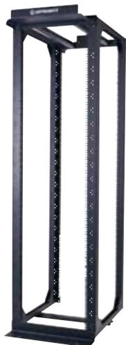
Серверные стойки Mighty Mo 10 совместимы со всеми стойками Mighty Mo 6 и 10, а также оборудованием для организации кабелей. Расстояние между монтажными направляющими регулируется от 317,5 до 762 мм независимо от конструктивных опор, что позволяет изменять их положение после установки стойки. Средства для организации вертикальными кабелями Mighty Mo могут устанавливаться спереди или сзади. Цвет черный
