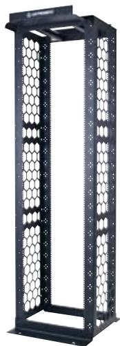
Конструкция стоек Mighty Mo 10 обеспечивает максимальный приток воздуха к сетевому оборудованию. Сотовая структура боковых стенок и разделительные перегородки комбинируются для управления всасываемыми и выпускаемыми воздушными потоками, создавая коридоры распределения холодных и горячих воздушных потоков для оборудования с боковым охлаждением. Нижний опорный фланец (уголок) может поворачиваться внутрь, что позволяет установить стойку на плитку фальшпола 610 x 610 мм
