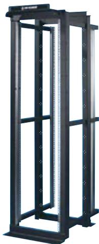
Положение монтажных направляющих регулируется в диапазоне 152,4-812,8 мм независимо от конструктивных элементов. Это позволяет установить на раму направляющие "половинной высоты", чтобы размещать в одной стойке оборудование с разными требованиями к глубине. Цвет черный. Конструкция: алюминиевая рама со стальными направляющими EIA, регистрация UL
