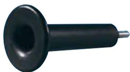
Катушка снабжена интегрированным штифтом с резьбой M12-24, и ее можно устанавливать в отверстия EIA на любых стойках Ortronics. Катушки можно использовать для крепления кабельных органайзеров и патч-панелей или устанавливать в любом месте, где требуется дополнительная организация кабелей. Цвет черный
