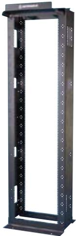
Стойки Mighty Mo 6 выпускаются в вариантах с глубиной канала 266,7 и 412,8 мм. Стойки 412,8 мм предназначены специально для тяжелого или крупного оборудования. Нижний опорный фланец (уголок) в модификации 412,8 мм может поворачиваться внутрь, что позволяет установить стойку на плитку фальшпола 610 x 610 мм. Цвет черный, регистрация UL
