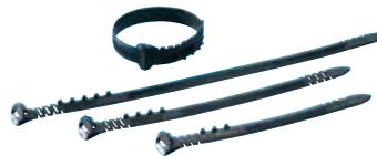
Разъемные кабельные стяжки с предохранителем. Простым нажатием на защелку стяжку можно открыть для корректировки или повторного использования. Запатентованный предохранитель предотвращает чрезмерное затягивание кабелей передачи данных. Упаковка по 50 шт в коробке
