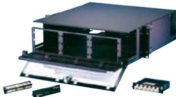
Новые оптические полки для оптоволоконных сетей Ortronics серии FC предназначены для коммутации и установки оптических муфт. Корпус глубиной 482,6 мм обеспечивает больше пространства для внутренней организации оптических волокон и оптимизирован для применения со стойками Mighty Мо 6 глубиной 266,7 мм. Доступны варианты высотой 1, 2, 3 и 4 U
