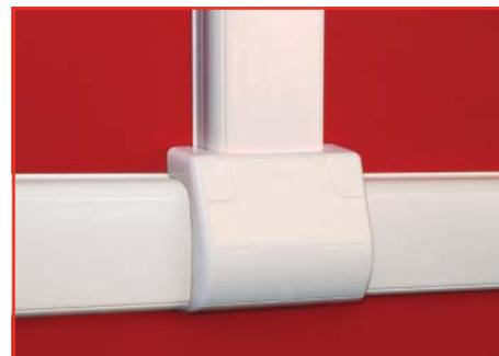
Установите накладку тройника без адаптеров (для кабель-каналов 90x25 мм). Сдвиньте крышки в нужное положение до фиксации под накладкой тройника
