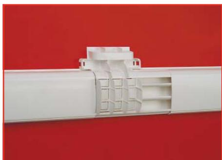
Установите базу отвода на кабель-канал и закрепите на стене. Для отведения проводки удалите ненужные участки перфорации
