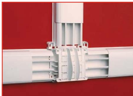
Вставьте в базу тройника отводимый кабель-канал. Используйте разделитель тройника для отвода проводки под углом 90°. Удалите ненужные участки перфорации
