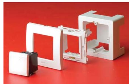
Второй тип - коробки PDD (под изделия "Viva"), PDB (под изделия "Brava"), PDM (под изделия 45x45 мм) и PDG (под изделия Gewiss). В коробки монтируются соответствующие электроустановочные изделия (2 модуля) защелкиванием, без рамок и каркасов. С 4-х сторон коробки имеют перфорацию под все типоразмеры миниканалов серии ТМС.
