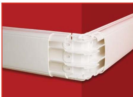
Установите базу угла в кабель-канал. Вставьте в базу угла вторую часть кабель-канала и закрепите его на стене
