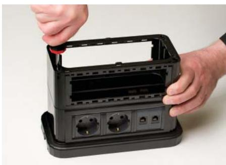
При необходимости высоту башенки можно наращивать с помощью вертикального расширения (код 09091), которое монтируется вместо крышки основной башенки (в комплекте с расширением поставляются 4 самореза, перегородка, 2 рамки и 1 заглушка для закрытия пустого проема)
