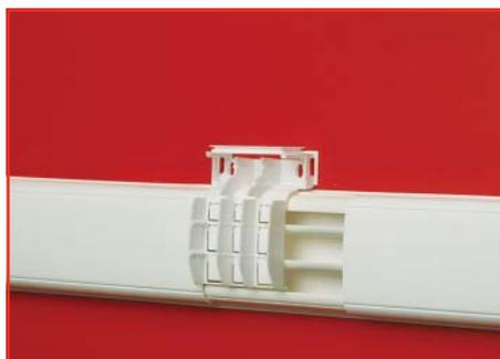
Установите базу отвода на кабель-канал и закрепите на стене. Для отведения проводки удалите ненужные участки прерфорации
