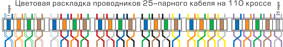
Цветовая раскладка шести 4-парных кабелей на 110 кроссе
